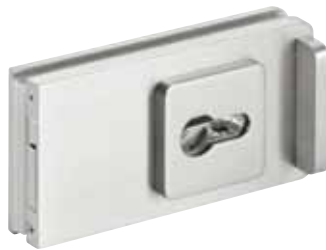
Glas-Schiebetürschloss PZ Edelstahl gebürstet Mit aufgesetzter kantiger PZ-Rosette und Hakenfalle Für Glasdicke 8 - 12 mm 99414
