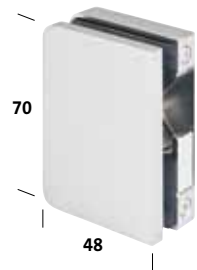
Gegenkasten zu Schiebetürschloss Edelstahl gebürstet Für zweiflügelige Türanlage Montage auf Türblatt Für Glasdicke 8 - 12 mm 99418
